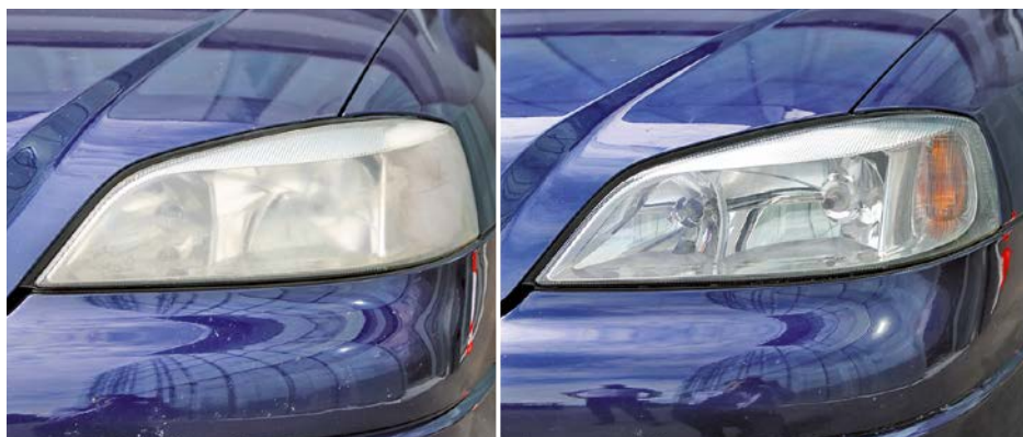
Fig. 1. Des projecteurs jaunis réduisent la luminosité et défigurent le véhicule. L'effet avant / après est nettement visible.
