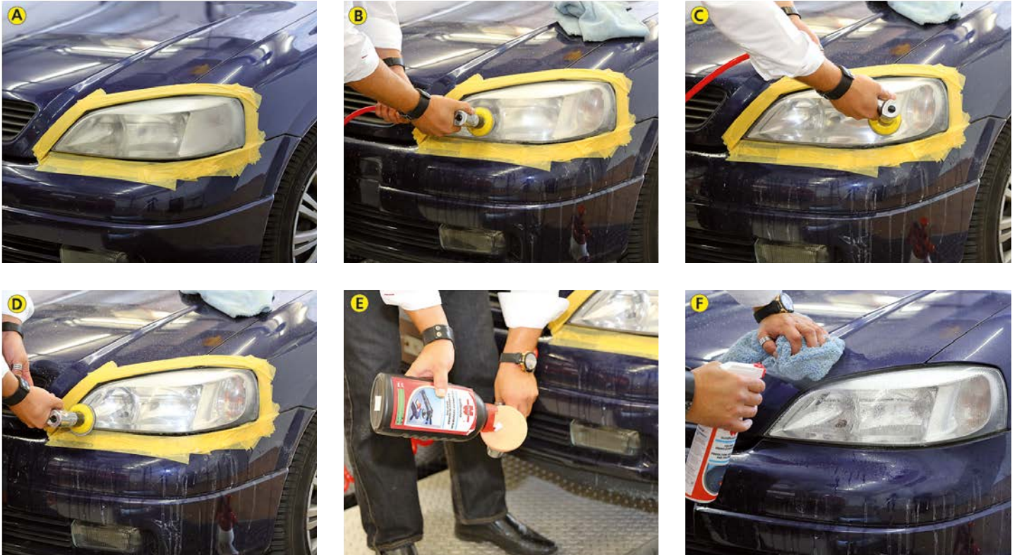
Fig. 3. Étapes les plus importantes dans la remise en état des projecteurs. A : coller un ruban de masquage adhésif sur les pièces environnante, B à D : polir à l'eau avec du papier abrasif 1000, 2000 et 4000, E : polir avec de la pâte à polir rapide, F : sceller avec du spray polymère.
