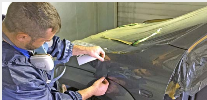
Contrôle des teintes 3M PPS : le film est fixé sur le véhicule afin d'en contrôler la teinte.
